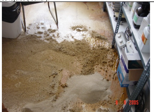
Es varen abocar uns 50 kg de vermiculita sobre el vessament
