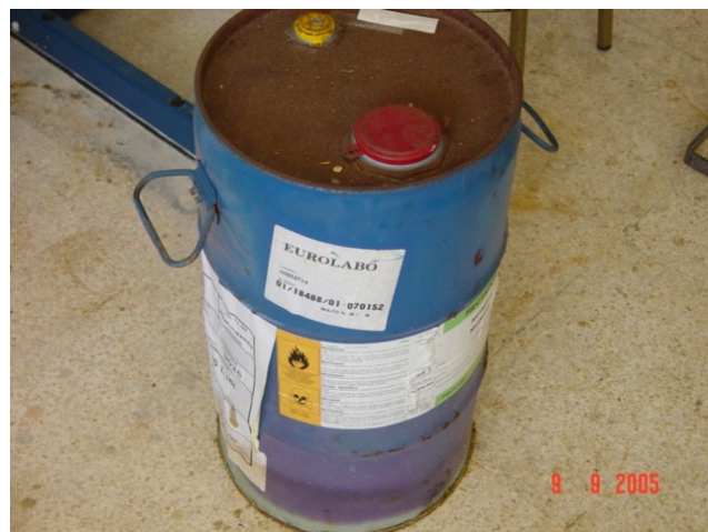
Bidó de metanol que estava just a devora el bidó d'àcid nítric (vegeu el rovell de la base)
