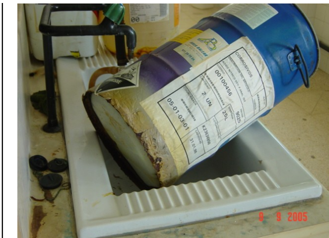
Estat en el que es trobava el bidó d'àcid nítric
