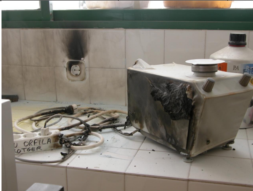
Detall de la balança i cables que s'han cremat.
