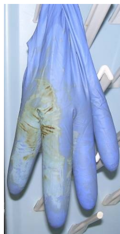
Guant ple d'aigua per comprovar l'estanquitat
