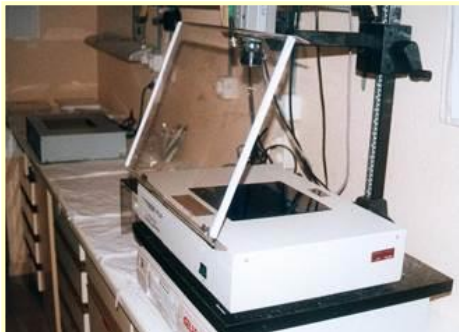
Transil·luminador (UV) amb pantalla de metacrilat
