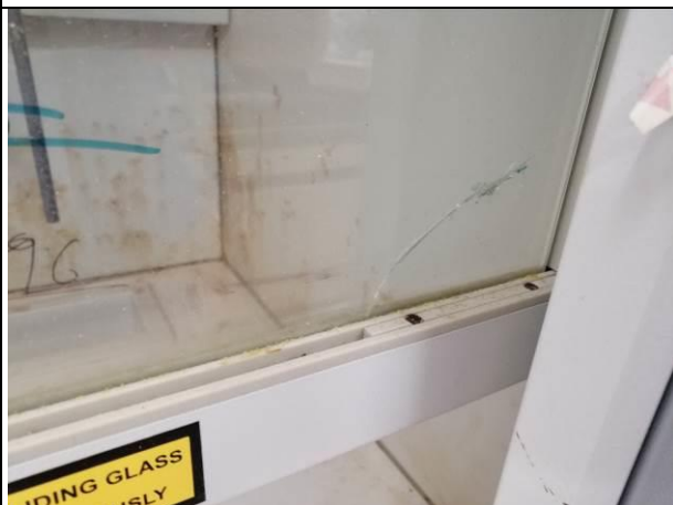
3. Fissures a la pantalla de vidre, fruit de l'explosió.
