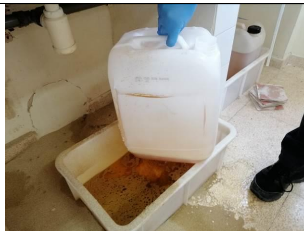
6. Bidó de dissolvents clorats que va explotar. Vegeu com el líquid bull a la safata de retenció.
